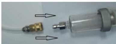
4. Connectez le tuyau d'aspiration à la machine au niveau du raccord inférieur.
