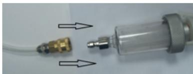
4. Connettere il tubo di aspirazione alla macchina nella connessione inferiore.
